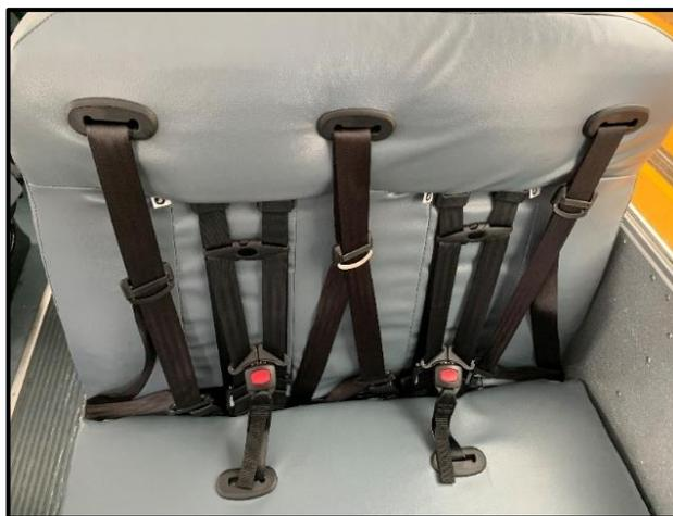
Figure 5. Système de retenue à cinq points
