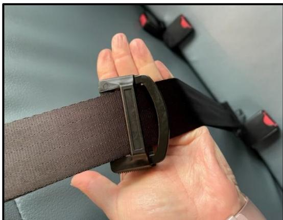
Figure 1. Ceinture-baudrier et dispositif de réglage en hauteur
