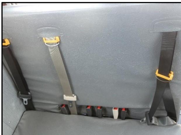
**Figure 7. Exemple de ceinture de sécurité centrale et de boucle colorées (non utilisées dans les autobus pilotes)**
